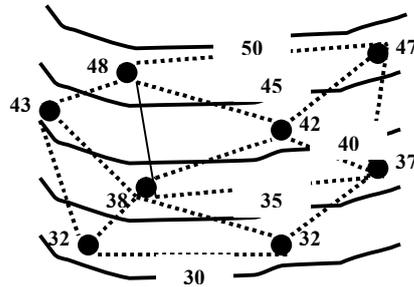
Se entre 2 pontos cotados existir uma linha de água, não se pode fazer directamente a interpolação entre esses 2 pontos, visto entre eles o declive não ser constante.
