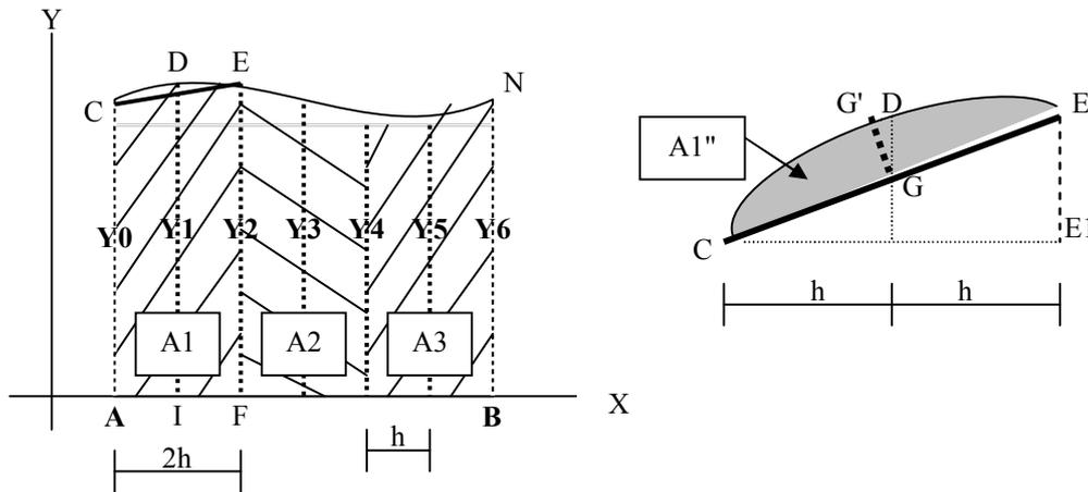
Se a curva que limita a área que pretende medir for fechada (figura seguinte), então  $y_0 = y_n = 0$  e a expressão de Simpson será:  $A = h/3 (2*(y_2 + y_4 + \dots + y_{n-2}) + 4*(y_1 + y_3 + \dots + y_{n-1}))$ .
