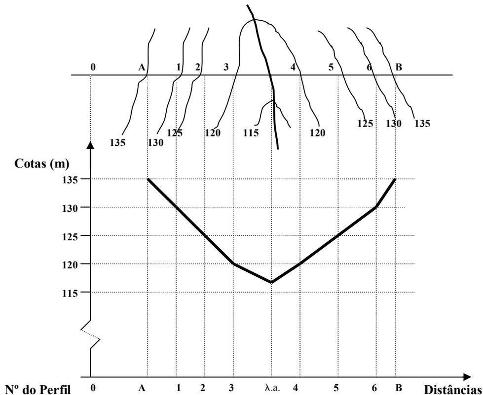
Na figura anterior encontra-se a representação de um perfil vertical do terreno segundo a recta AB, a partir de uma planta topográfica. A planificação do perfil é representada num sistema de eixos ortogonais, encontrando-se representadas em abcissas as distâncias e em ordenadas as cotas.
