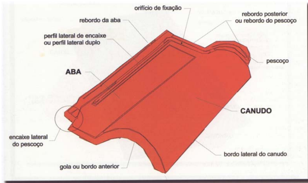
Fig. 19 – Esquema visto de cima da telha lusa
