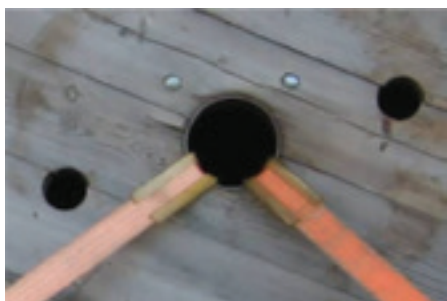
Figura 22: Proteção em bordos cortantes
