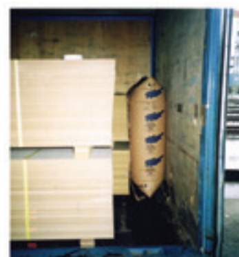
Figura 29: Almofada de ar para bloqueio lateral
