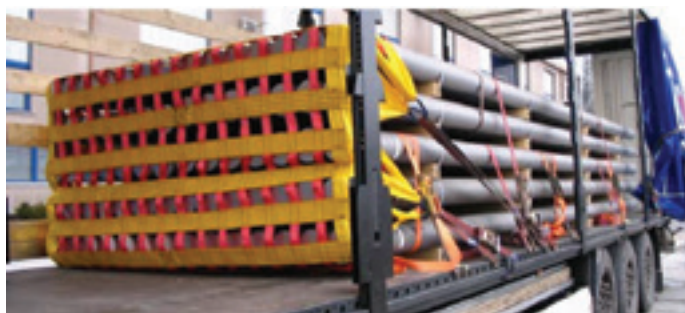
Figura 32: Imobilização com rede e amarração direta na direção da frente
