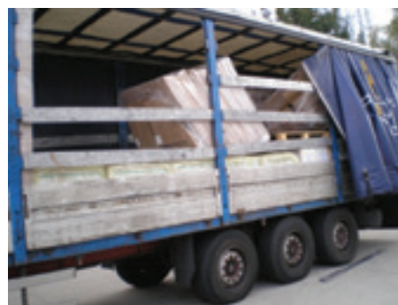
Figura 19: imobilização de carga insuficiente apenas por meio de película extensível
