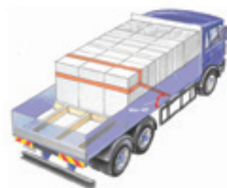
Figura 40: Amarração com lançantes utilizando uma linga
