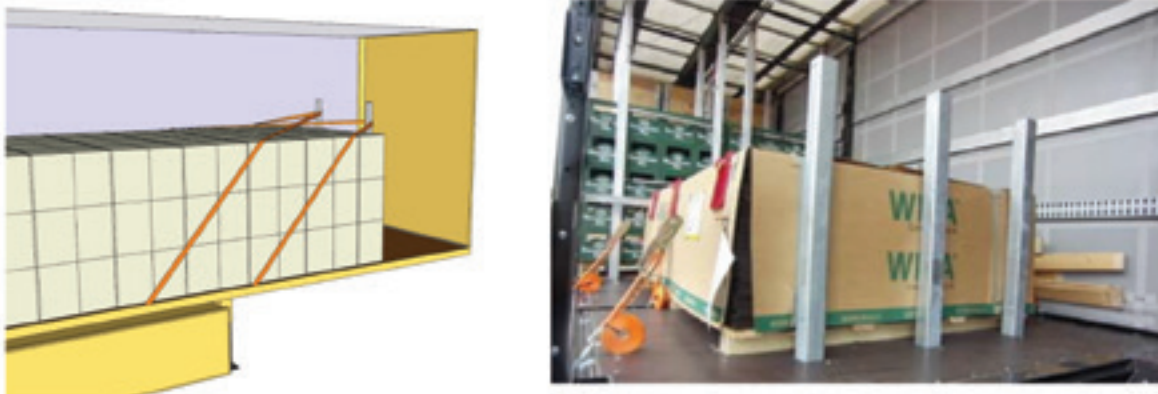
Figura 7: Escoras utilizadas para bloqueio para a frente
