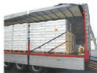
Figura 39: Amarração com lançantes utilizando paletes
