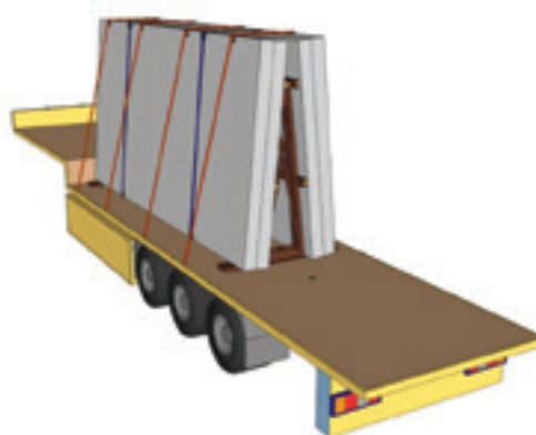
Figura 48: Método de imobilização através da combinação de bloqueio, armação em A, amarração envolvente e amarração de topo
