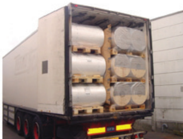
Figura 28 Material de enchimento entre filas de carga
