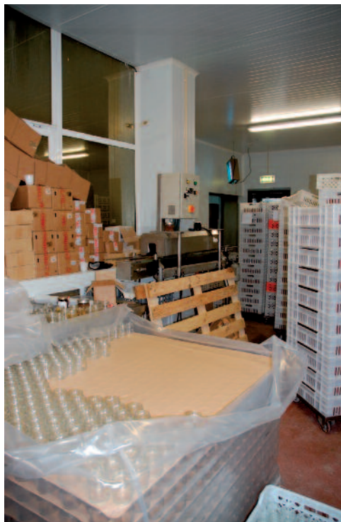
FIGURA 163 Obstrução das vias de passagem e do quadro eléctrico, que não apresenta sinalização.
