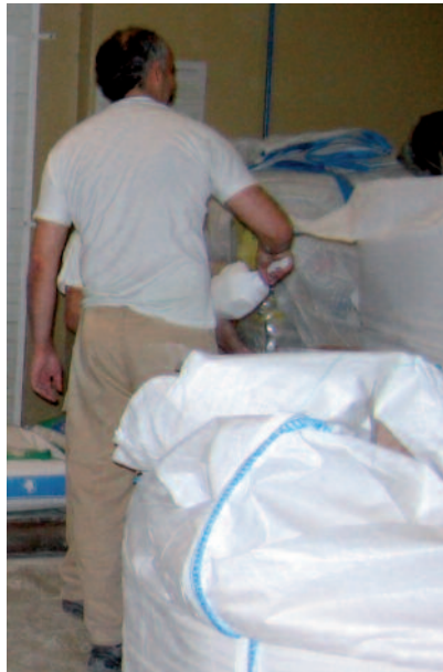
FIGURA 41 Exemplo de más práticas: Ensaque de farinha sem sistema de exaustão
