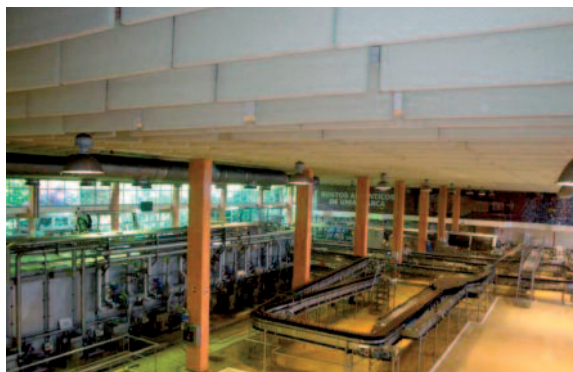
FIGURA 28 Painéis atenuadores de ruído numa linha de enchimento
