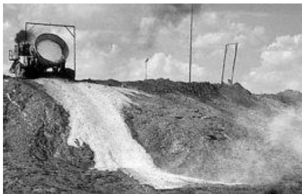
Figura 76: Descarte da escória de alto-forno.
