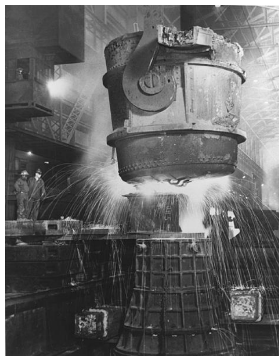
Figura 80: Enchimento das lingoteiras circulares.
