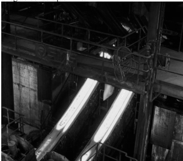
Figura 84: Lingotamento contínuo em dois veios.
