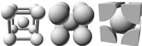
Figura 14: Representação esquemática de uma célula unitária da estrutura Cúbica de Corpo Centrado (CCC).
