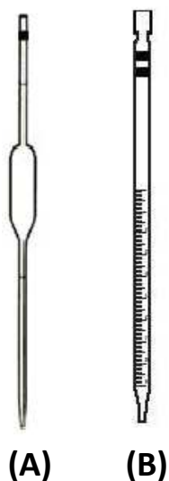
Figura 2.1 – Tipos de pipetas: em (A), uma pipeta volumétrica de uma faixa (medição exata); e, em (B), uma pipeta graduada de duas faixas (esgotamento total).
