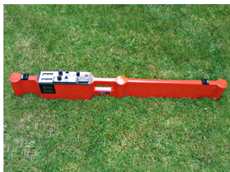
Figura 5 – Sensor de condutividade eléctrica aparente do solo por indução electro-magnética EM38 da GEONICS
