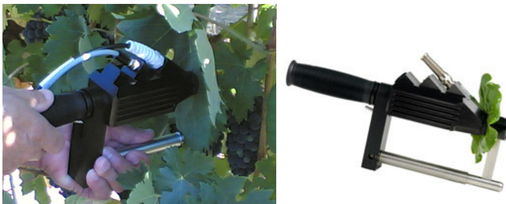
Figura 39 – Medição das reflectâncias de uma folha no campo (esquerda); Perfil do Leaf-Clip (direita)
