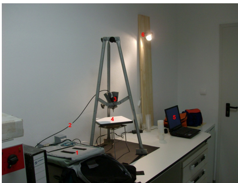
Figura 40 – Instalação para a medição das reflectâncias. (1) Espectroradiómetro; (2) Cabo de fibra óptica; (3) Sensor; (4) Placa de calibração; (5) Computador; (6) Fonte de iluminação (halogéneo - 75W)
