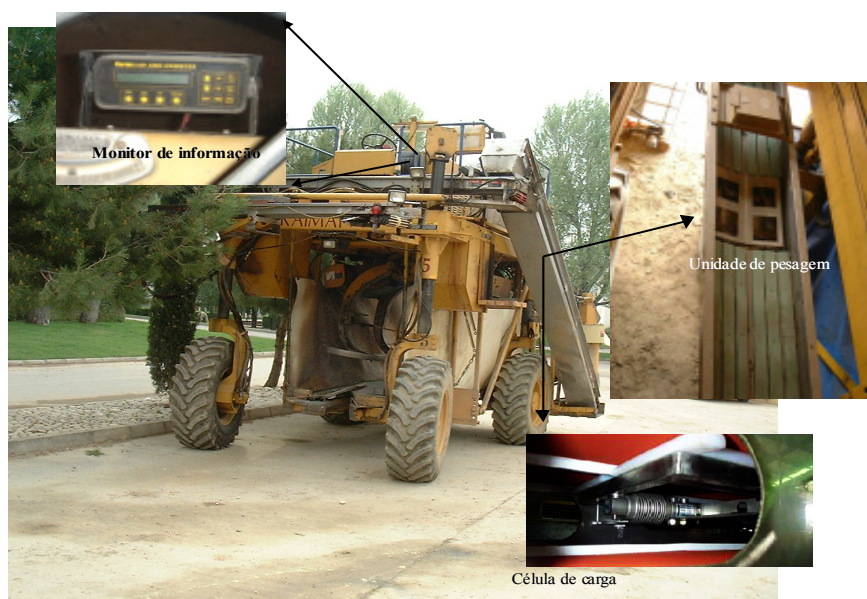
Figura 2 – Monitor de produtividade para vindimadoras sem tegão baseado em células de carga no tapete de descarga lateral
