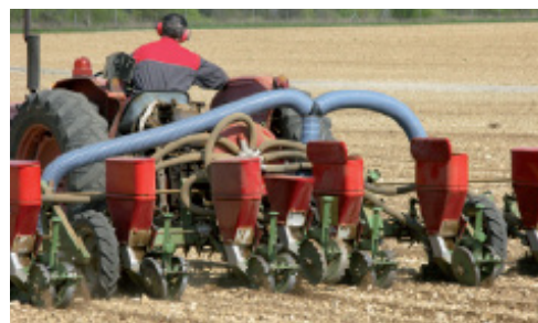
Semeadores pneumáticos equipados com defletores | Bayer Cropscience
