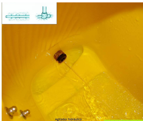
Agitador hidráulico
