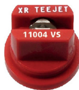
Bico vermelho específico da TEEJET. Débito a 4 bar 1,85 l/min
