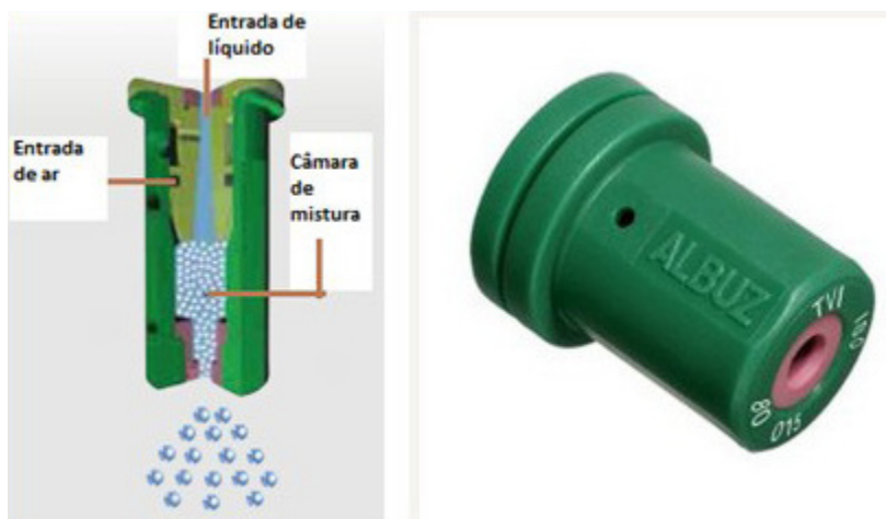
Esquema de funcionamento de um bico anti-arrastamento | Fonte: adaptado de ALBUZ
