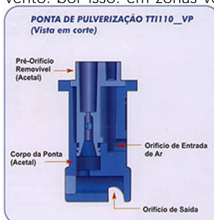
Esquema de funcionamento de um bico anti-deriva | Fonte: Teejet/Albuz
