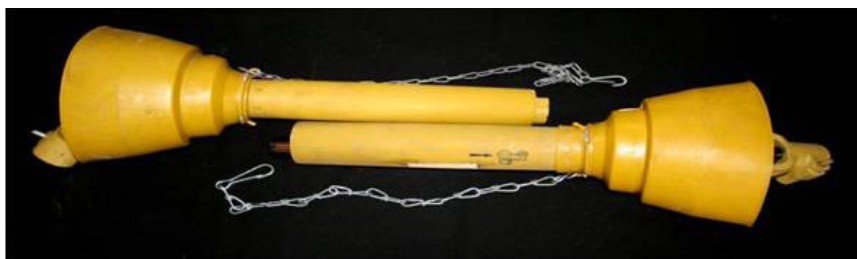
Resguardo protetor do Cardan | Fonte: FOR.MA.AGRI
