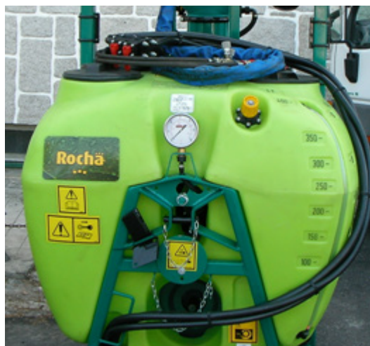
Depósito principal Exemplo dos diferentes depósitos dos pulverizadores
