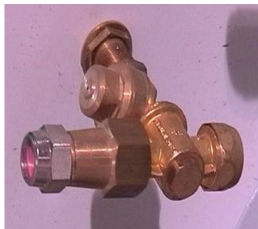
Bico cônico ou de turbulência que equipa uma turbina
