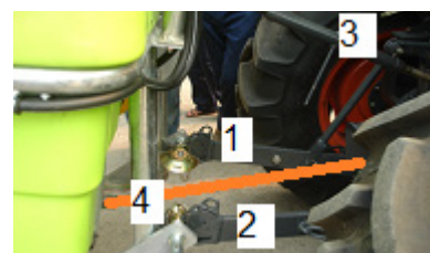
1 - Engate da barra de tração esquerda (tirante fixo); 2 - Engate da barra de tração direita (tirante móvel); 3 - Engate da barra do terceiro ponto; 4 - Engate do veio telescópico de cardans.
