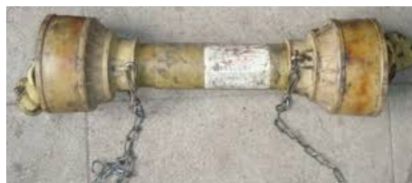
Veio de TDF e veio telescópico de cardans com resguardos e dispositivos de imobilização (correntes)
