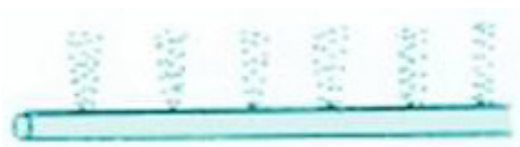
Agitador pneumático | Fonte: Jorge Carvalho
