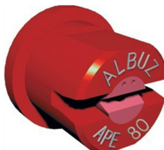
Bico vermelho específico da ALBUZ. Débito a 4 bar 1,4 l/min
