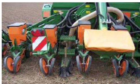
Semeadores pneumáticos equipados com defletores | Bayer Cropscience
