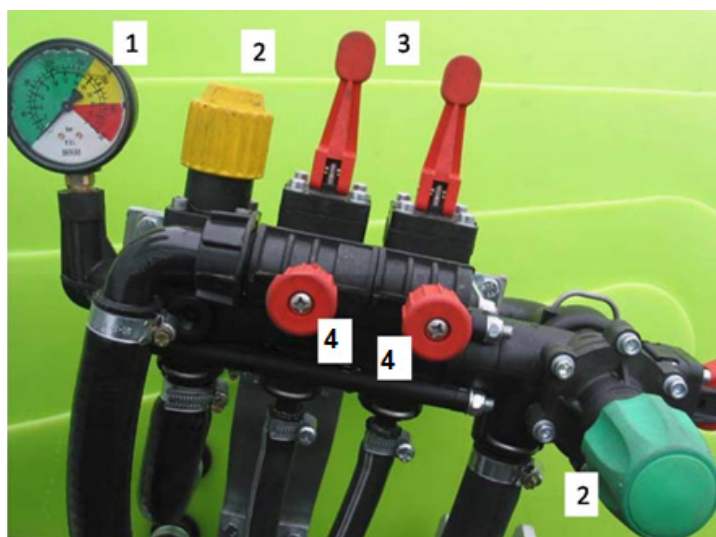
Distribuidor com comando volumétrico mecânico. 1 – Manómetro; 2 – Parafusos reguladores de pressão; 3 – Seletor dos setores; 4 – Parafusos de calibragem;
