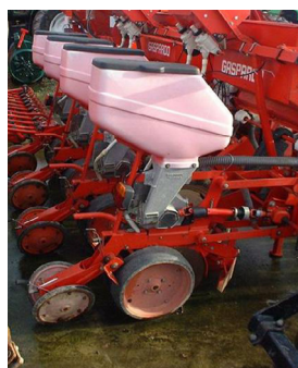
Semeador com distribuidor de micro grânulos
