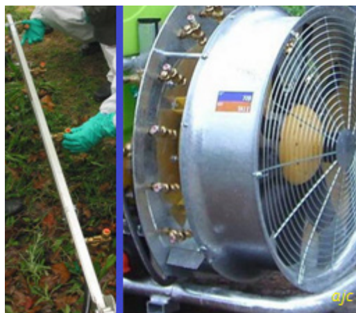
Exemplos de Bicos (barra horizontal/ turbina) Fonte: Jorge Carvalho
