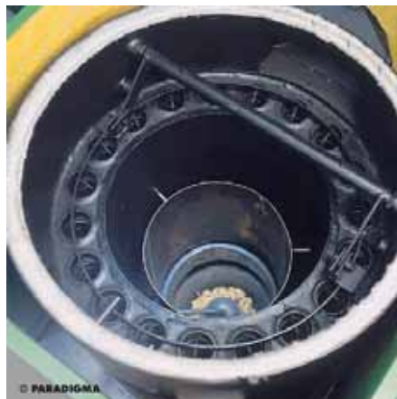
Figura 5.36 – Permutador de calor com sistema de limpeza automática
