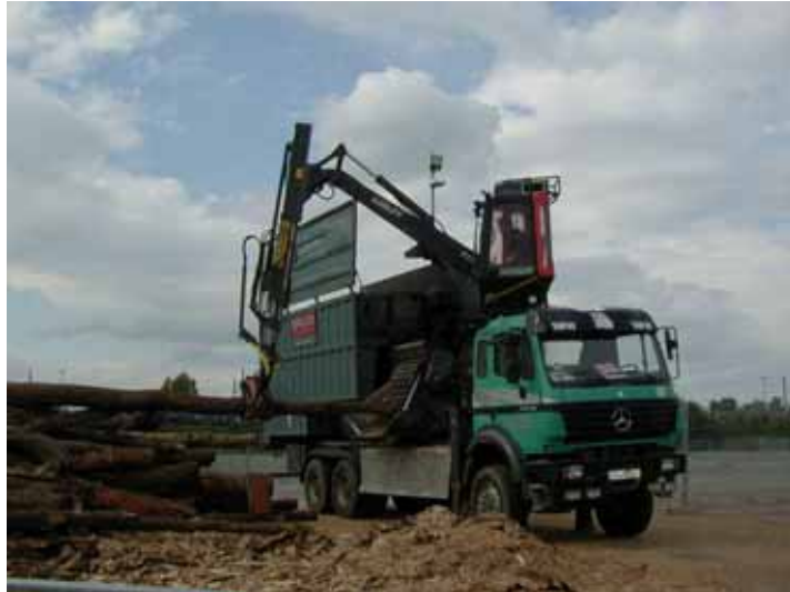
Figura 2.47 - Cortador cilíndrico para 100m 3 de estilhas de madeira por hora
