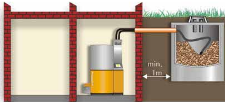
Figura 5.64 - Depósito subterrâneo exterior
