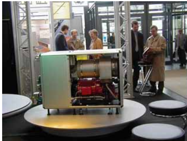
Figura 2.68 - Sistema de cogeração stirling com 10 kWe de saída
