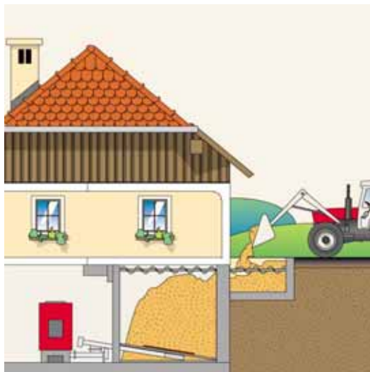
Figura 5.69 - Depósitos de estilha de madeira com transportadores de parafuso de alimentação
