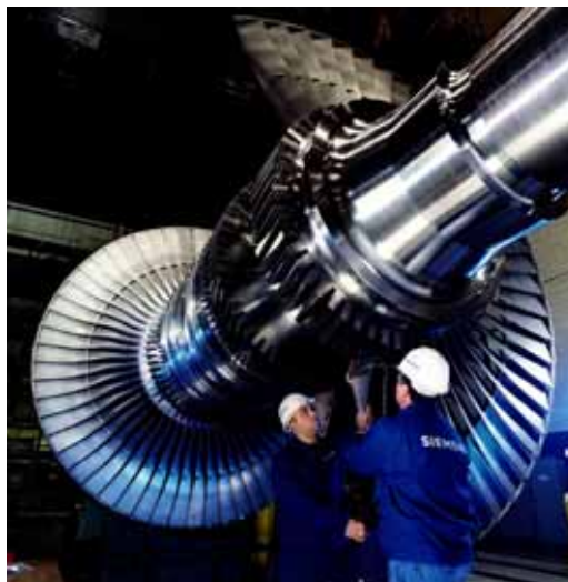
Figura 2.70 - Montagem de uma turbina a vapor
