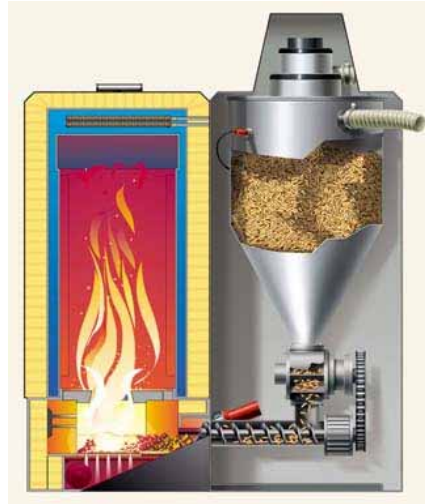
Figura 5.31 – Secção de caldeira com sistema de retorta para pellets
