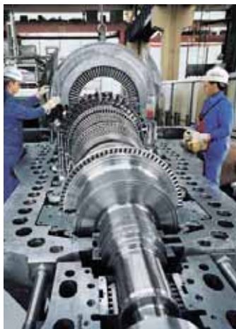
Figura 2.71 - Montagem de uma turbina a gás
