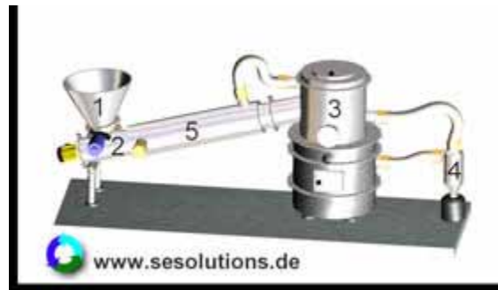
Figura 7.5 - Estrutura de um gaseificador a madeira baseado no princípio de Joos
